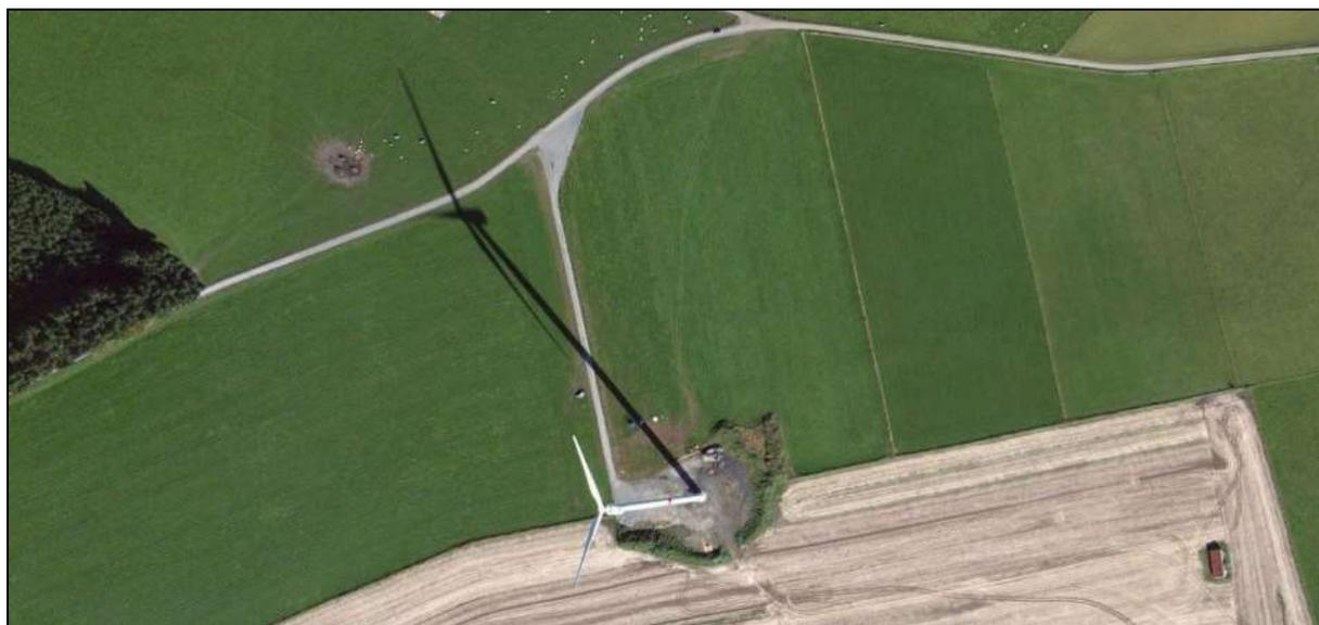
Figure 4-8 : Ombre d'une éolienne. L'observateur placé dans l'ombre du rotor subit un effet d'ombre mouvante.
