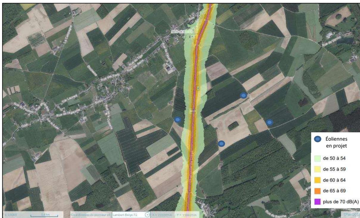
Figure IV.5-1 : Localisation des éoliennes projetées et isoniveaux de bruit LNIGHT calculés à 4m H/TN le long de la nationale N63 (Source : A-Tech ; environnement.wallonie.be)
