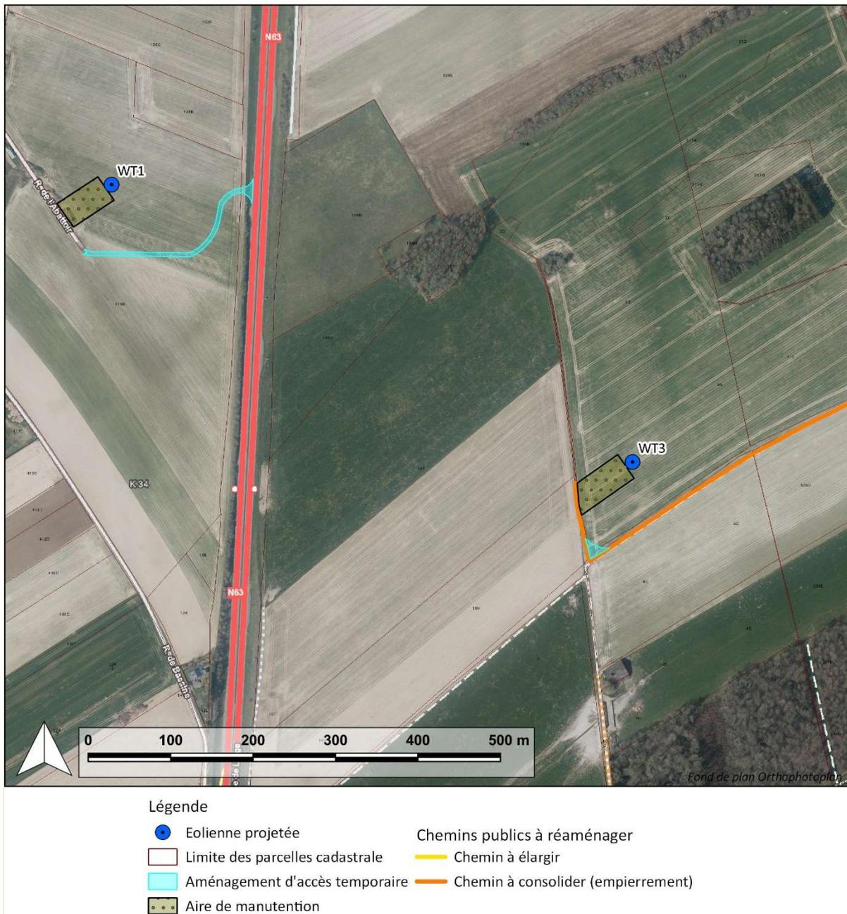
**Figure III.4-8 : Vue aérienne des aires de montage des éoliennes 1 et 3**
