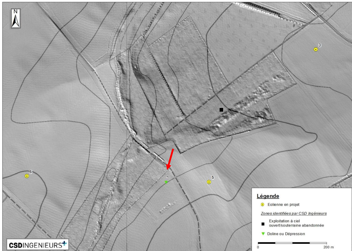
Figure 31 : Localisation des anciennes exploitations artisanales situées entre les éoliennes n°5, 6 et 3. La flèche rouge indique une anomalie de surface non identifiée (site karstique possible) aujourd'hui invisible sur le site (probablement remblayée par un agriculteur).
