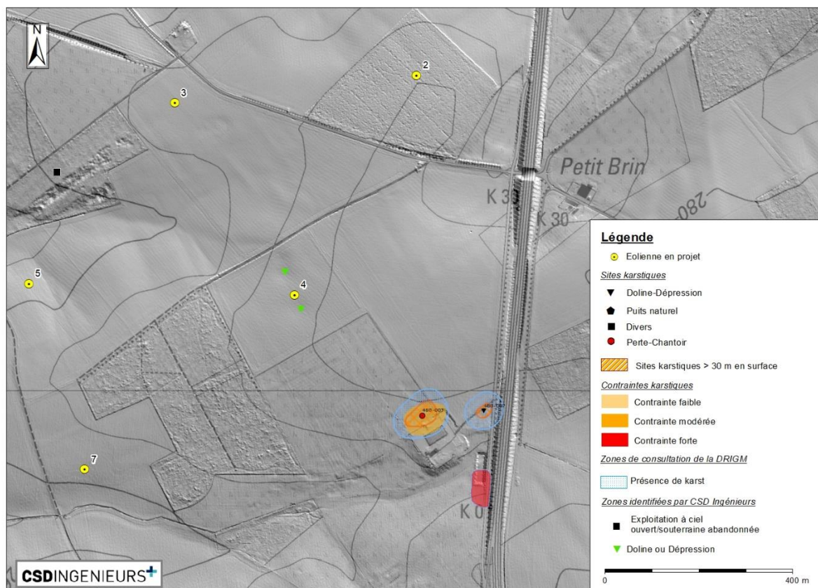
Figure 32 : Localisation du chantoir du Petit Brin et de la dépression du Petit Brin à environ 380 m au sud-est de l'éolienne n°4. La zone hachurée orange représente la zone de contrainte karstique de 25 m renseignée dans le remise d'information complémentaire de la Direction des risques industriels géologiques et miniers (30 m selon le Géoportail de Wallonie).
